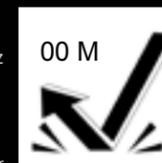
**Resistencia al impacto** se expresa como la altura, medida en metros, desde la cual se puede dejar caer la linterna sobre hormigón sólido sin que se altere su funcionamiento. Para esta certificación, la linterna probada no debe presentar rajaduras o roturas visibles y debe funcionar perfectamente.
