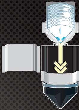
**1.** Coloque el receptáculo sellado del cedazo en el dosificador, con las lengüetas de distribución del filtro hacia adelante.
